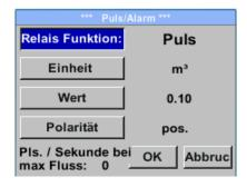
Der gal. getrennte Ausgang kann als Puls-oder Alarmausgang definiert werden. Änderung durch Anwahl Taste "Relais Funktion" mit Taste "△" und Wechsel mit Taste "OK".
