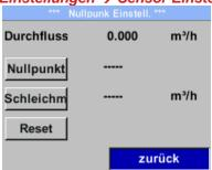
Durch Auswahl "Reset" werden Festlegungen für "Nullpunkt" bzw. "Schleichmenge" zurückgesetzt.
