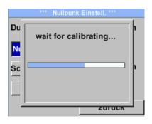
Zeigt der Sensor im eingebauten Zustand ohne Durchfluß bereits einen Durchflußwert von > 0 m³/h kann man hier den Nullpunkt der Kennlinie setzen.
