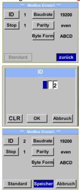
Um Änderungen, z.B. der Sensor ID, vorzunehmen, wird mittels Taste "△" das Feld "ID" selektiert und anschließend mit Taste "OK" ausgewählt.
