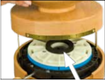
Foto 4 Kauçuk sünger contanın doğru yerinde olup olmadığını kontrol ediniz (ok) Huniyi geri yerleştiriniz ve pirinç vidalarını ayar kolu ile yerine sabitleyiniz.
