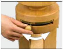
Foto 5 İncelik Seviye Ayarı: Sola doğru ince, sağa doğru kalın öğütme.
