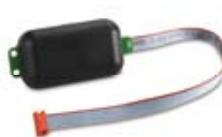
**Non optoisolated TTL/RS-485 serial interface | Interfaccia seriale TTL/RS-485 non optoisolata**
