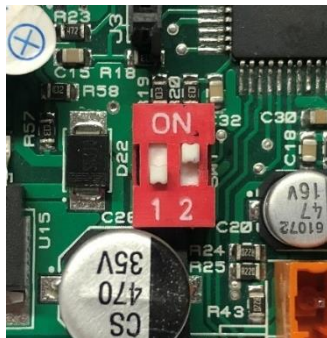
Şekil 10: Switch'in kart üzerindeki konumu ve yakından görünümü.
