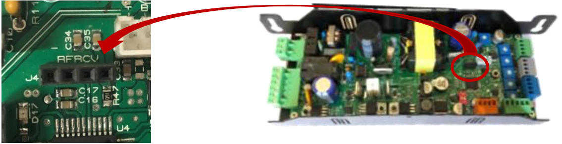
Şekil 7: RF alıcı soketinin kart üzerindeki konumu ve yakından görünümü.
