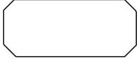
Köşeleri 45^{\circ} kesilmiş loop alanı (TAVSİYE EDİLİR)
