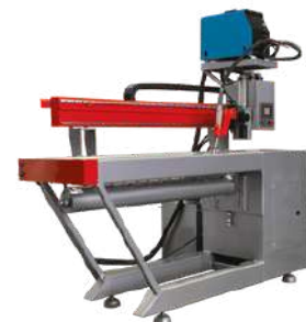
Longitudinal Welding Machines
