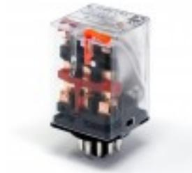
Serie di relè per ogni tipo di impiego, progettati per carichi sino a 10 A a 250V AC1 o 30V DC1, e assai diffusi in tutto il mondo per ogni tipo di applicazione industriale a causa della loro pratica connessione ad innesto su zoccoli Octal o Undecal.
