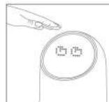
Sensör alanı, koyu renkli küresel ekranın üzerinde eğik olarak yer almaktadır. Herhangi bir nesne sensör alanına 0-15 cm civarında yaklaştığında, sensör kapağı otomatik olarak açılır ve logo yanar ve yanıp söner. Bu arada gözlük çerçevesi simgeleri yanar; Sensör alanından ayrıldıktan sonra, sensor kapağı 5 saniye sonra otomatik olarak kapanır, aynı zamanda gülén yüz simgeleri yanar ve yaklaşık 2 saniye süre, ardından trend ses seviyesi simgeleri yanıp söner ve 5 saniye süre
