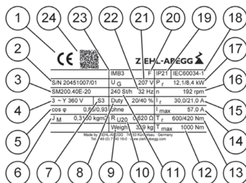
Figure 3-2-01 Example name plate ZAtop SM200.40E/SM200.45E
