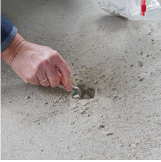
1. adım: Numune, alışıldığı gibi zemin kaplamanın tüm kesiti üzerinden alınır ve bir poşete doldurulur.
