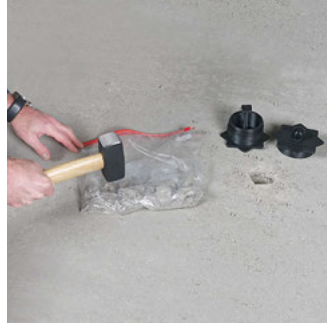
2. adım: Tüm kontrol objesi 8 mm'den küçük bir kum değerine sahip olacak şekilde numune malzemeyi parçalayın.
