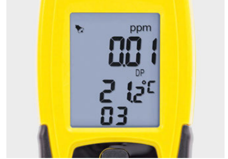
OZ-ONE'un arka plan aydınlatmalı LCD ekranı, eşzamanlı olarak, kötü aydınlatılmış ortamlarda da rahatça okunabilen iki ölçüm büyüklüğünü gösterir.
