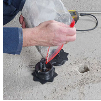
3. adım: Ölçüm hücresini malzeme numunesiyle doldurma.
