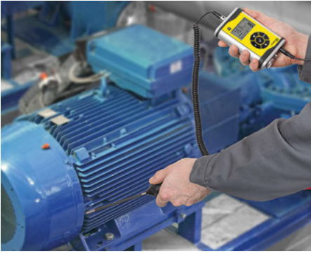
Paslanmaz çelik uçlu gövde ses sondası, dönen makine parçalarındaki yatak aşınma kontrolleri gibi NDT kontrolleri için optimum düzeyde uygundur.
