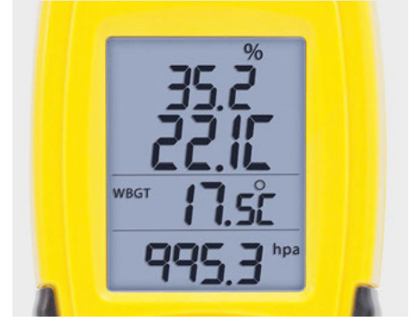
TC100'ün arka plan aydınlatmalı LCD ekranı, eşzamanlı olarak, kötü aydınlatılmış ortamlarda da rahatça okunabilen dört ölçüm büyüklüğünü gösterir.
