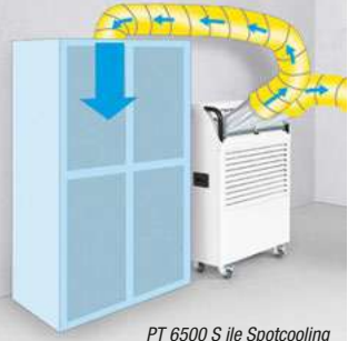
PT 6500 S ile Spotcooling kullanımının örnek şematik resmi.
