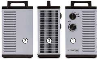
Isıtma cihazının ön (1) ve arka tarafındaki (2) çift hava girişi, güçlü radyal fanı, daha sonra sıcak hava akımı olarak tam yüzeyli şekilde yan üfleme ızgarası (3) üzerinden odaya üflenecek olan büyük hacimli emme havasıyla besler.
