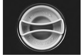
Arka tarafta eksene merkezi olarak entegre edilmiş fren sistemi
