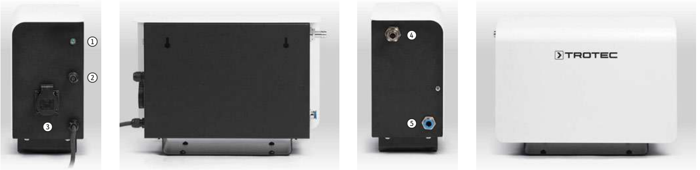
① Çalışma kontrol lambası, ② Doğrudan besleme yuvası, ③ Servis prizi, ④ Besleme hortumu bağlantısı, ⑤ Tahliye hortumu bağlantısı
