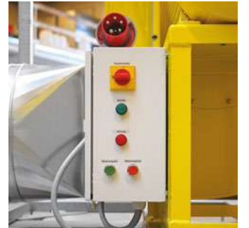
TFV 600 ve TFW 900, yumuşak çalışmaya başlama için standart olarak bir Yıldız-Üçgen devreye donatılmıştır.
